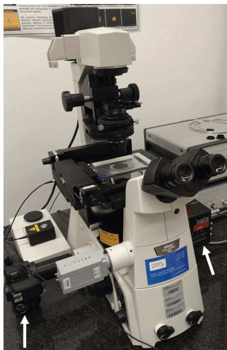
Slika 4.2.6: Polarizacijski optični mikroskop Nikon Eclipse Ti z nameščenim fotoaparatom za zajem visokoločljivih statičnih posnetkov (leva puščica) in visokoločljivo hitro kamero za snemanje hitrih mikroskopskih video posnetkov (desna puščica).
