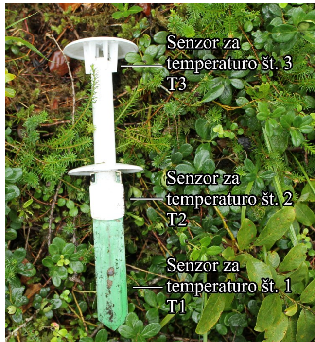
Slika 9: Merilna naprava (datalogger) za dolgoročno zajemanje podatkov – temperature, s prikazom položajev posameznih senzorjev (foto: S. Povhe).
