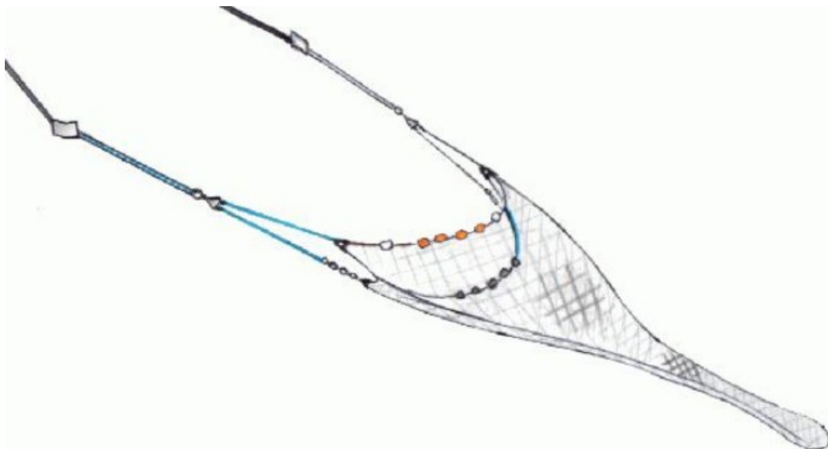
Slika 5: Pridnena vlečna mreža s širilkami tipa »volantina«. (Vir: MKGPRS, 2011)
