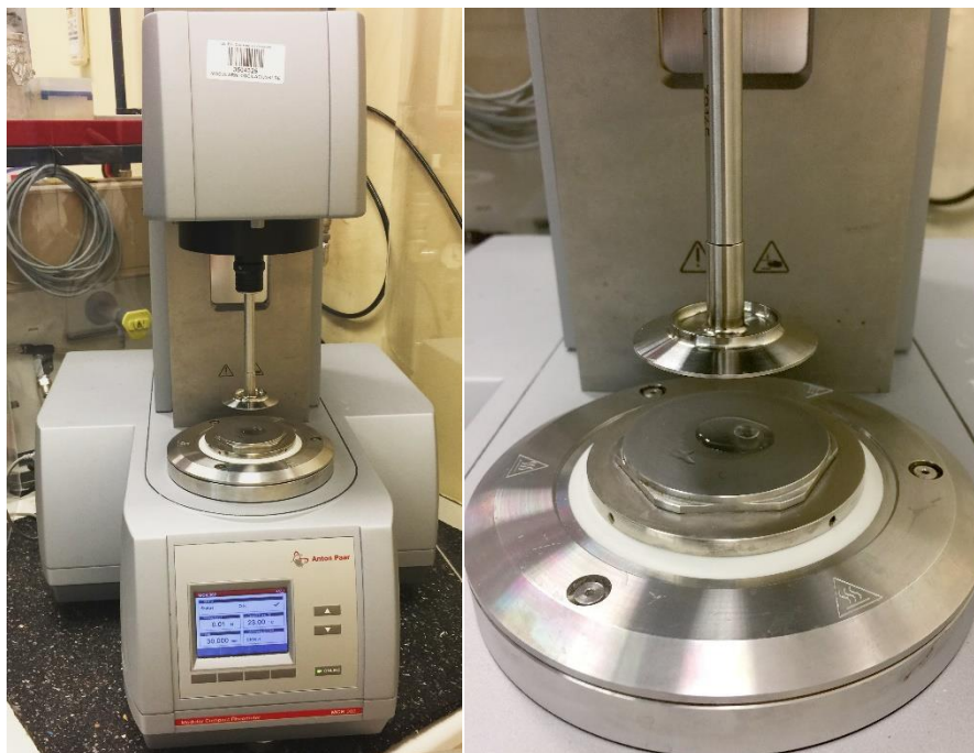
Slika 3.3: Rotacijski modularni reometer (Physica MCR 302, Anton Paar, Gradec, Avstrija).
