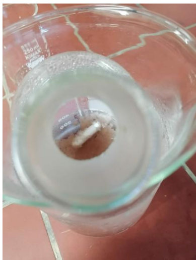
Slika 4: Ohlajanje produkta sinteze antifebrina/acetanilida v hladni vodi.
