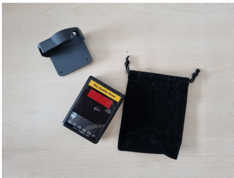
Slika 3. Fotometer Sky Quality Meter L s pripomočki za meritev svetlobne onesnaženosti.
