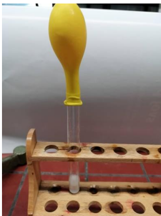
Slika 2: Reakcija med sodo bikarbono in kisom, pri kateri smo pridobili \text{CO}_2 .
