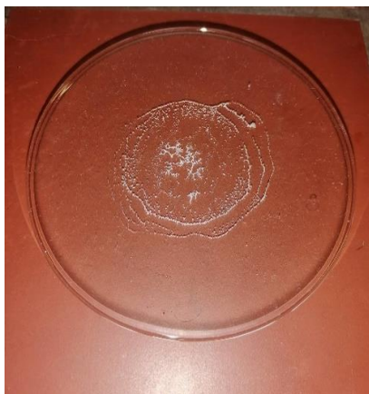
Slika 8: Ohlajanje raztopine s \text{CaSO}_4(\text{aq}) in po enem dnevu izločeni kristali \text{CaSO}_4 \cdot 2\text{H}_2\text{O} , gipsa, na urnem steklu.
