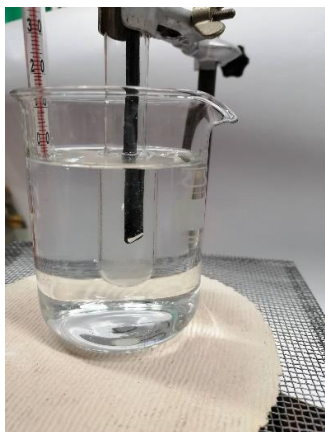
Slika 7: Segrevanje epruvete na vodni kopeli pri temperaturi 40 °C in vbrizgavanje kisika.
