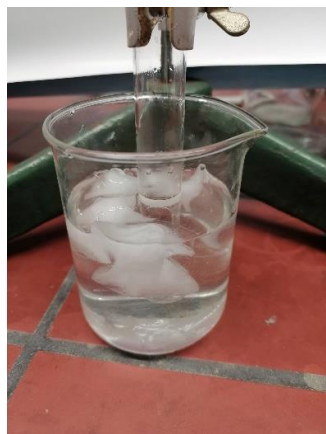
Slika 8: Ohlajanje raztopine s \text{CaSO}_4(\text{aq}) in po enem dnevu izločeni kristali \text{CaSO}_4 \cdot 2\text{H}_2\text{O} , gipsa, na urnem steklu.
