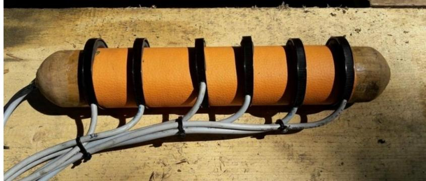
Slika 2. Model človeške roke z nameščenimi temperaturnimi senzorji.
