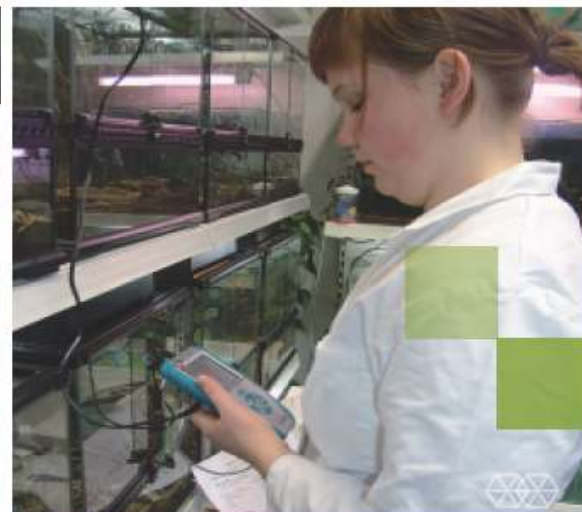
> Merjenje temperature v terariju kobilic pri različni oddaljenosti senzorja od talnega grelca
