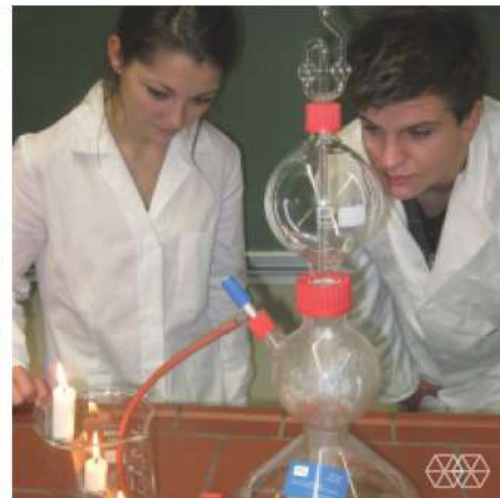
> Kippov aparat za razvijanje plinov
