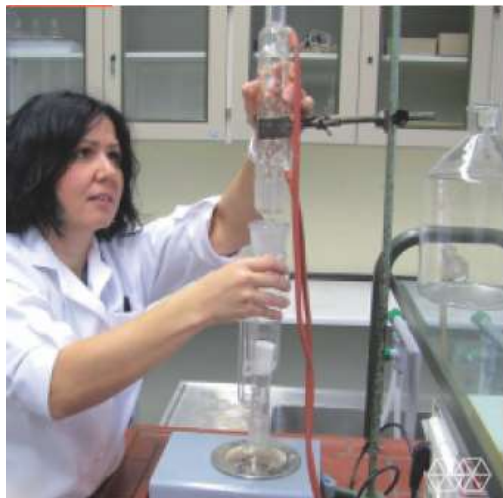
> Prikaz ekstrakcije s Soxhletovim aparatom
